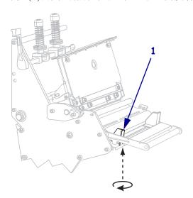
10. 将外侧介质导板 (1) 完全滑出。
