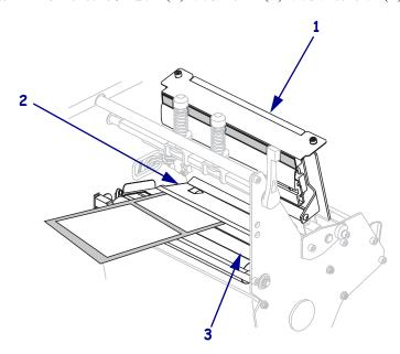
8. 将介质与内侧介质导板 (1) 对准。将外侧介质导板 (2) 推入,直到它刚好接触到介质边缘。
