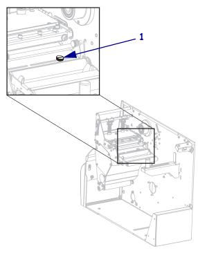
3. 使用扁平头螺丝刀,松开顶部介质传感器调节螺钉。
