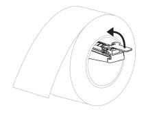
**d.** 将介质送入介质导板,直到它刚好接触到成卷介质边缘。
