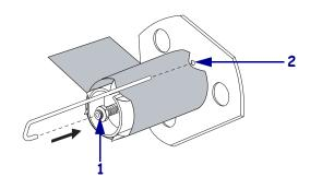
18. 将轴逆时针旋转几圈,让色带卷绕在轴钩上,并收紧松弛部分。
