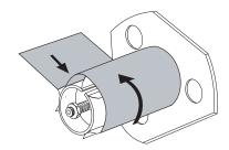
**a.** 重新装上轴钩。将轴钩较短的一端插入调节螺母中心的打孔中 (**1**)。将轴钩较长的一端插入导板的小孔中 (**2**)。
