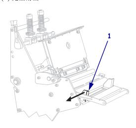
**11.** 如果打印机带有介质张力调节总成 (**1**),应将介质从介质张力调节总成滚轮下穿过。对于所有打印机而言,都应将介质从介质导板滚轮 (**2**) 和顶部介质传感器 (**3**) 下方穿过。
