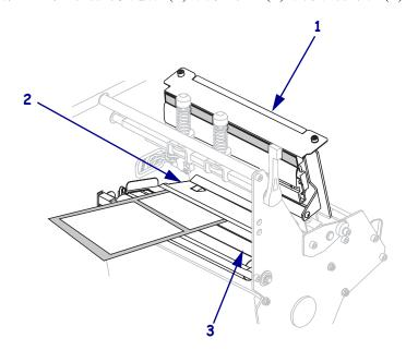
**13.** 从打印机中将介质拉出大约 920 毫米 (36 英寸)。从这段露出的介质上取下标签并 丢弃。
