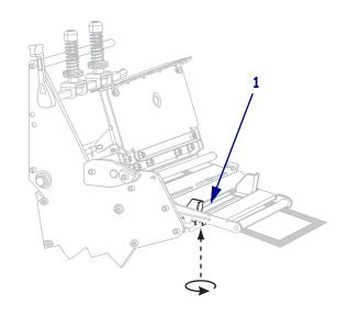
10. 将打印头总成(1)按下,然后顺时针旋转打印头打开杆(2),直到将其锁定到位。
