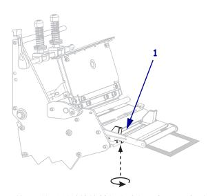
21. 将打印头总成 (1) 按下, 然后顺时针旋转打印头打开杆 (2), 直到将其锁定到位。
