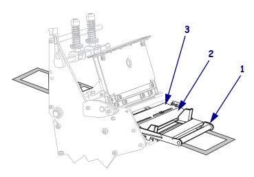
12. 将介质前推,直到它从打印头总成(1)下方,卡盘(2)下方和打印辊(3)上方穿过。
