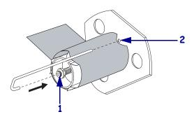
b. 将轴逆时针旋转几圈,让色带卷绕在轴钩上,并收紧松弛部分。
