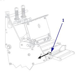
**6.** 如果打印机带有介质张力调节总成 (**1**),应将介质从介质张力调节总成滚轮下穿过。 对于所有打印机而言,都应将介质从介质导板滚轮 (**2**) 和顶部介质传感器 (**3**) 下方 穿过。
