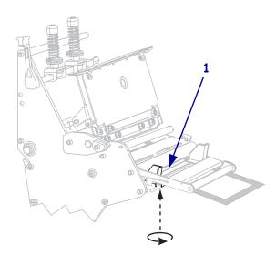
15. 将打印头总成 (1) 按下, 然后顺时针旋转打印头打开杆 (2), 直到将其锁定到位。
