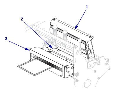
8. 将介质与内侧介质导板 (1) 对准。将外侧介质导板 (2) 推入,直到它刚好接触到介质 边缘。
