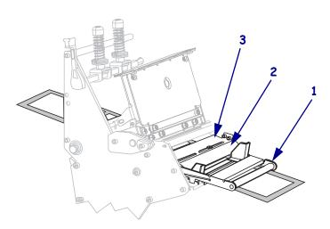
7. 将介质前推,直到它从打印头总成(1)下方,卡盘(2)下方和打印辊(3)上方穿过。
