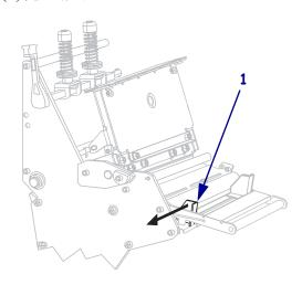
7. 如果打印机中带有介质张力调节总成 (1), 将介质从介质张力调节总成滚轮下穿过。 对于所有打印机而言, 都应将介质从介质导板滚轮 (2) 和顶部介质传感器 (3) 下方 穿过。
