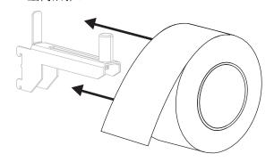
**c.** 将介质送入介质导板,直到它刚好接触到成卷介质边缘。
