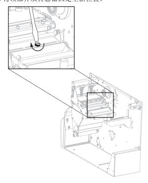
**6.** 根据顶部介质传感器调整后的新位置,调整底部介质传感器位置。请参见第 80 页的*底部介质传感器*。
