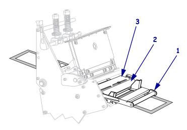
8. 将介质前推,直到它从打印头总成(1)下方,卡盘(2)下方和打印辊(3)上方穿过。
