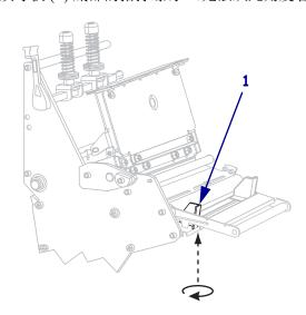
6. 将外侧介质导板 (1) 完全滑出。
