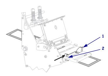
9. 拧紧位于外侧介质导板 (1) 底部的指拧螺钉 (无法从此角度看到)。
