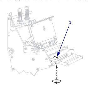
5. 将外侧介质导板 (1) 完全滑出。
