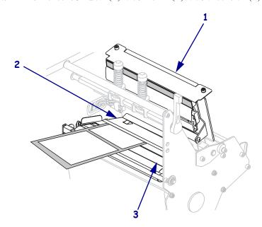
**9.** 从打印机中将介质拉出大约 920 毫米 (36 英寸)。从这段露出的介质上取下标签并丢弃。
