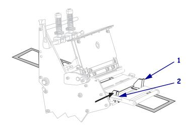
14. 拧紧位于外侧介质导板 (1) 底部的指拧螺钉 (无法从此角度看到)。
