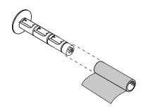
5. 色带引头能够简化色带的装卸操作。您是否已将纸或其它类似物品连接到色带末端 作为色带引头?
