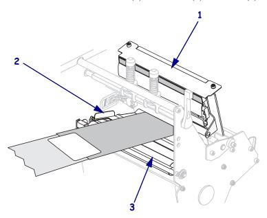
9. 将色带引头穿过顶部色带辊轮 (1) 上方,并穿向色带拾取轴 (2)。
